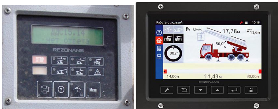
Рисунок 4. Слева – блок индикации типа БИ04.3, справа – блок индикации с TFT дисплеем
