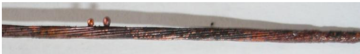
а) проводник, находившийся в изоляции в момент протекания сверхтока
