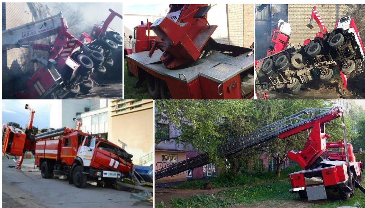
Рисунок 1. Аварии пожарных АЛ и АПК, полученные при проведении учений или в ходе проведения аварийно-спасательных работ
