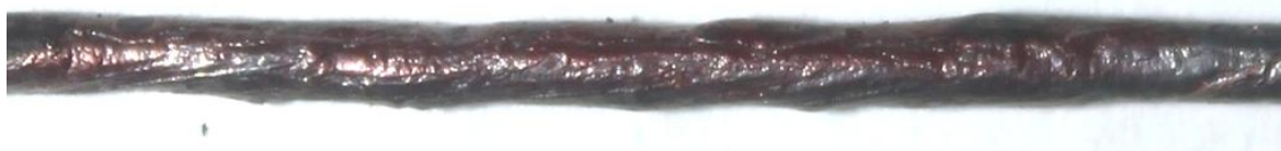
б) проводник, находившийся без изоляции в момент протекания сверхтока
