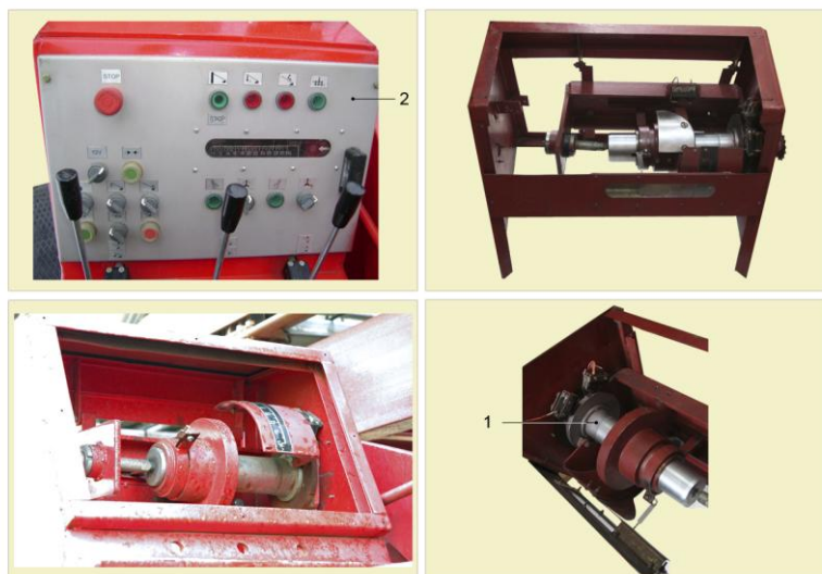
Рисунок 2. Механический прибор безопасности, установленный на основном пульте управления АЛ-30 (131) ПМ 506Д
