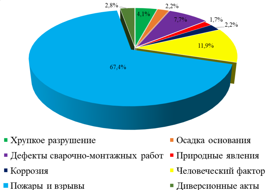
Рисунок 4. Причины аварий на резервуарах с нефтью и нефтепродуктами
