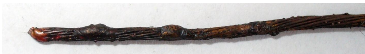
Рисунок 3. Вид медного проводника, подвергнутого токовой перегрузке свыше 4 \div 5 крат
