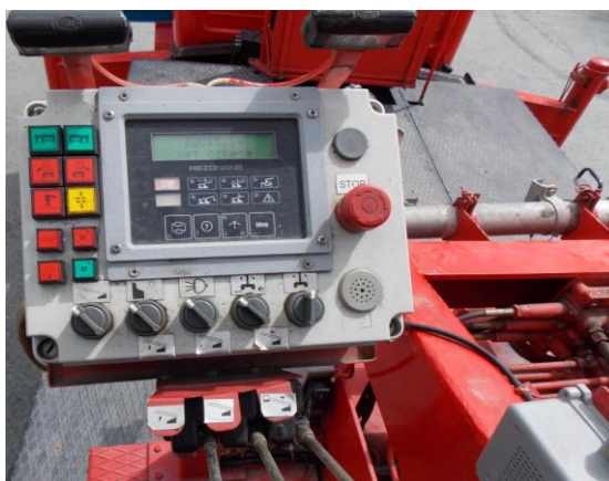
Рисунок 3. Основной пульт управления АЛ-30 (43206) ПМ 506У с блоком индикации прибора безопасности ПБЛ 240-01
